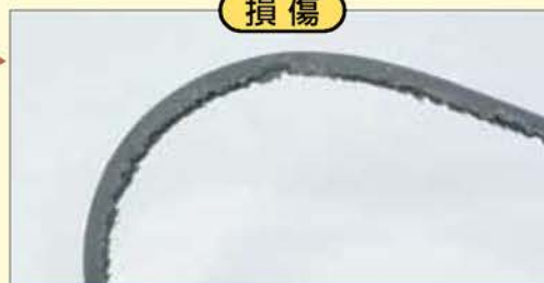
焼付き 被覆のはがれ き裂
